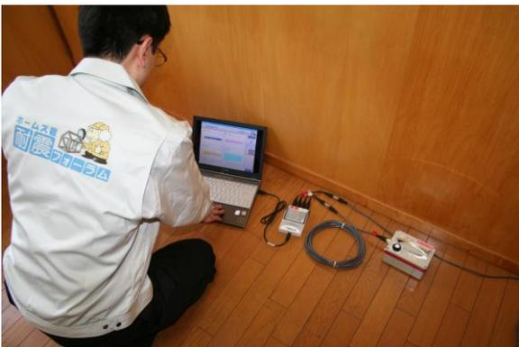
図 3-1 常時微動の計測風景
