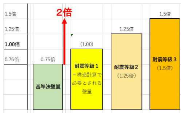
図4 基準法壁量と耐震等級壁量の比較
